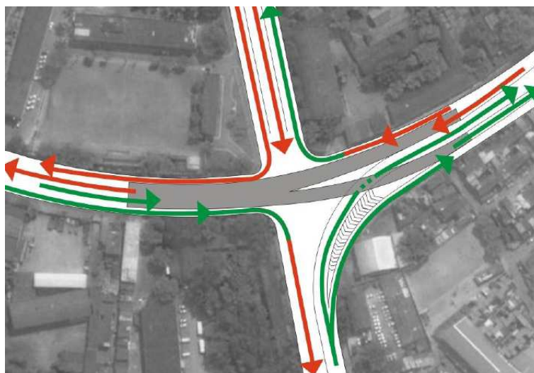
Figura 23: Viaduto sobre a Av. Jansen de Melo. Fonte: LERNER, 2009.
