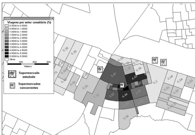
Figura 3: Mapa de porcentagem do total de viagens por setor censitário para um dos supermercados estudados.
