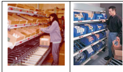
FIG. 4.1 Sistema picking-by-light (SITES TÉCNICOS)
