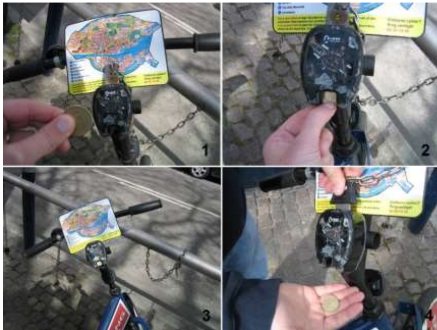
Figura 2.9: Procedimento para utilização das bicicletas do sistema City Bikes . Basta inserir a moeda (quadro 2) para destravar a bicicleta, enquanto a inserção do cadeado retorna a moeda (quadro 4). Fonte: Cycle Guide DK (2010)
