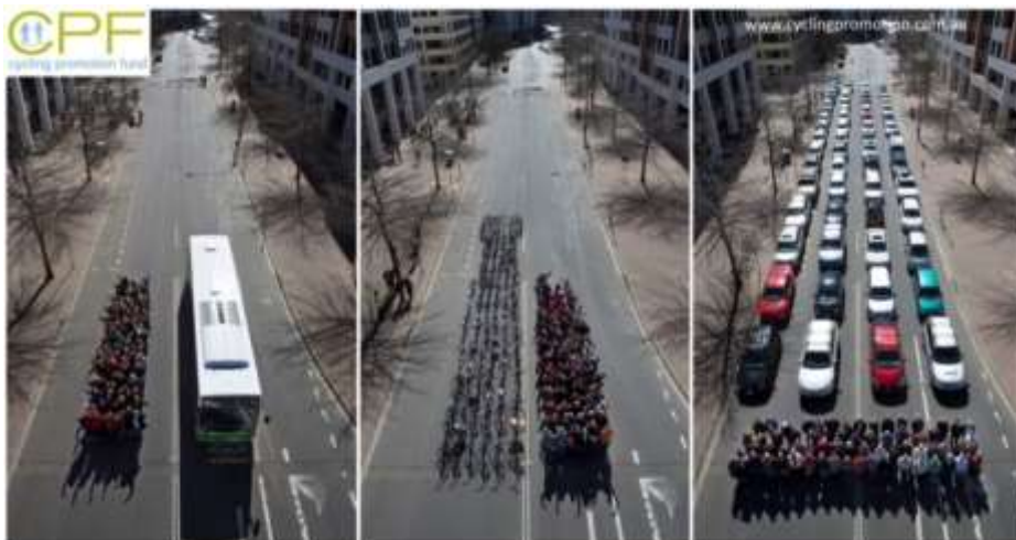
Figura 2.1: Espaço na via necessário para transportar a mesma quantidade de pessoas através de ônibus, bicicletas e carros. Fonte: Cycling Promotion Fund (s. d.)
