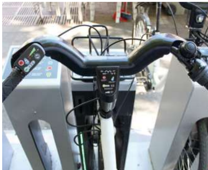
Figura 2.12: Guidão de uma e-bike do sistema BiciMAD. Fonte: BiciMAD (2014)
