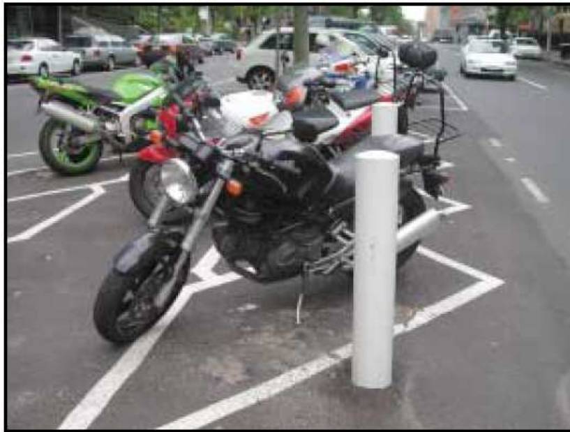
FIGURA 3-1 - Exemplo de dispositivo de segurança para estacionamento de motocicletas (VICROADS, 2001a)
