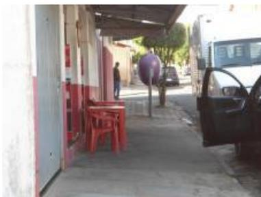
**Figura 99 - Largura efetiva da calçada inadequada devido à obstrução permanente**
