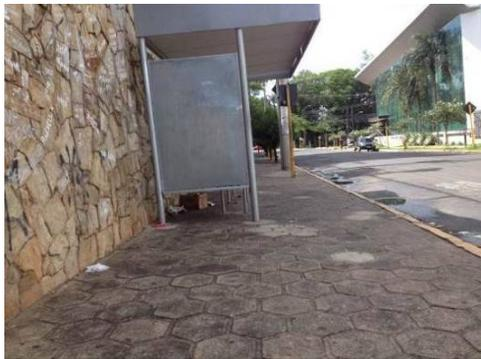
Figura 40 - Pontos de ônibus sem sinalização tátil, informações, espaço para cadeira de rodas e banco
