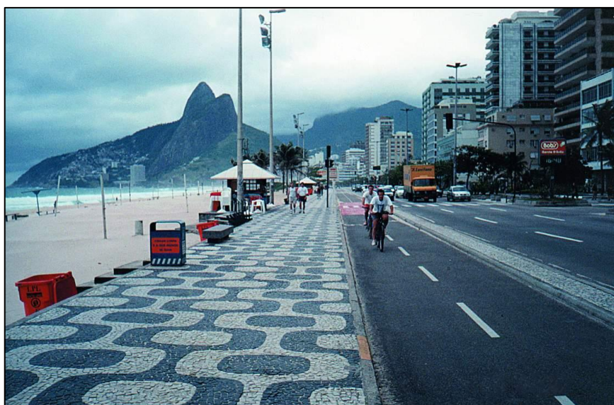
Figura 2.5: Exemplo de espaço cicloviário totalmente segregado no Rio de Janeiro (GEIPOT, 2001)
